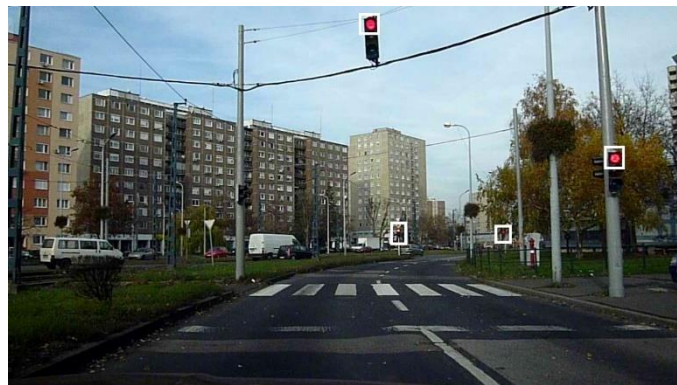
47. ábra Álló helyzetben felismert jelzéskép. A legkisebb felismert méret r=2 pixeles kör, de a JPEG artifact jelenség miatt az algoritmusnak ez a legtöbb esetben azért problémát okoz.
