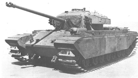
203. kép: Az A45, későbbi nevén FV201 univerzális harckocsi egy példánya. 1192
