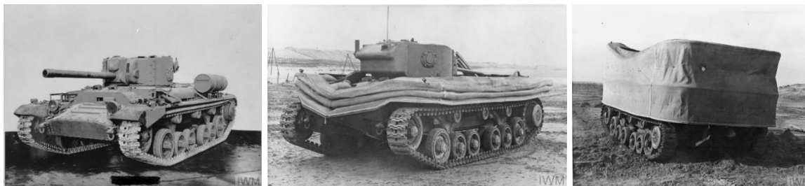
151. kép: A Valentine Mk. IX (balra), 940 illetve az altípus egy DD-vé alakított példánya (középen és jobbra). 941
