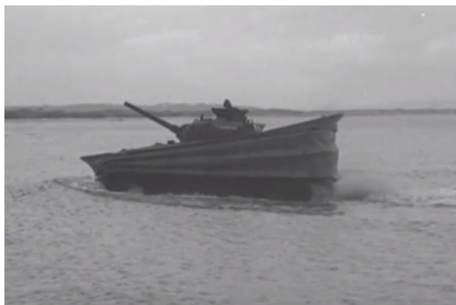
165. kép: Egy Sherman DD félig felemelt ponyvával ér partot. 1003
