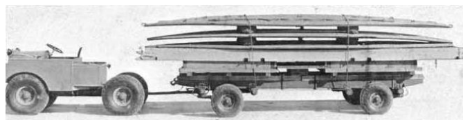
64. kép: Nicholas Straussler Mountain Tractorja egy általa tervezett utánfutón általa tervezett összecukható csónakokat vontat. 463
