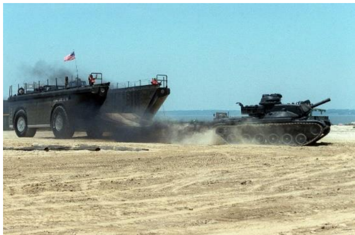
221. kép: Az amerikai LARC-LX „fedélzetéről” indított M60A2 alapharckocsi eltörpül a gigantikus szállítójármű mellett. 1287 Ha megépült volna, a Straussler HET is ehhez hasonló méretekkel rendelkezett volna.
