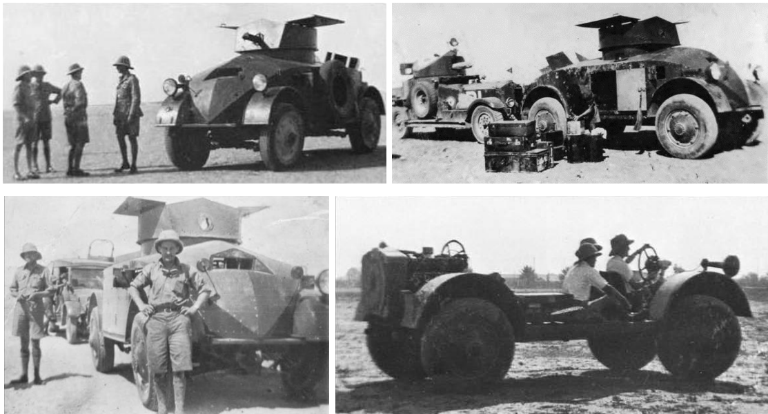
21. kép: Az AC-2 a sivatagi próbái során. A jobb felső képen az AC-2-es mögött egy olyan Rolls-Royce páncélaútó is látható, amelyek leváltására hozták létre eredetileg Straussler páncélgépkocsijait. 218
