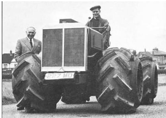
219. kép: Egy Straussler által épített teherautó Lypsoid kerekekkel, a feltalálóval a kép bal oldalán. 1271
