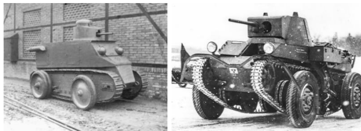
98. kép: Váltótálpas harckocsik külső kerekkel: a csehszlovák KH 50 (balra) 617 és a svéd Strv fm/31 (jobbra). 618
