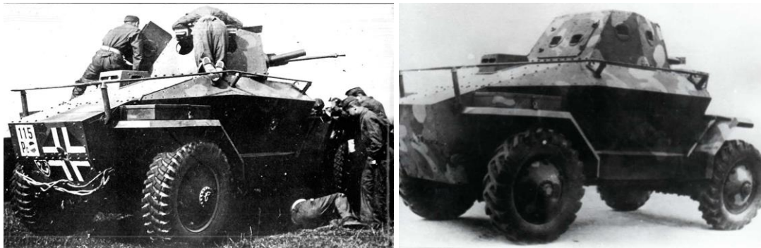
46. kép: A Cordatic régebbi (balra) és új, „sarkantyús” gumibroncsai (jobbra). 381
