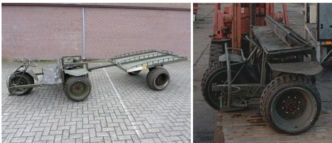
228. kép: Az FN AS 24 üzemkész állapotban a hozzá tervezett utánfutóval, illetve összecsucokott, szállítási állapotban. 1319
