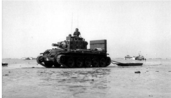
186. kép: Egy mélygázló kiegészítővel is ellátott kanadai A27L Centaur IV harckocsi egy Porpoise-t vontatva száll partra a Juno partszakaszon a D-napon. 1088
