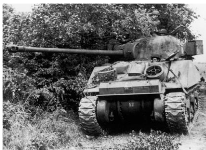
206. kép: Egy Sherman VC harckocsi. 1201 A hosszú, 17 fontos löveg nem tette egyszerűvé a DD rendszer párosítását a Sherman Firefly-okhoz.
