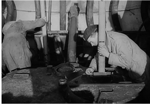
156. kép: A Sherman DD tornyán a parancsnok periszkópjához csatlakoztatják épp a ponyva miatt szükséges toldalékot. 956
