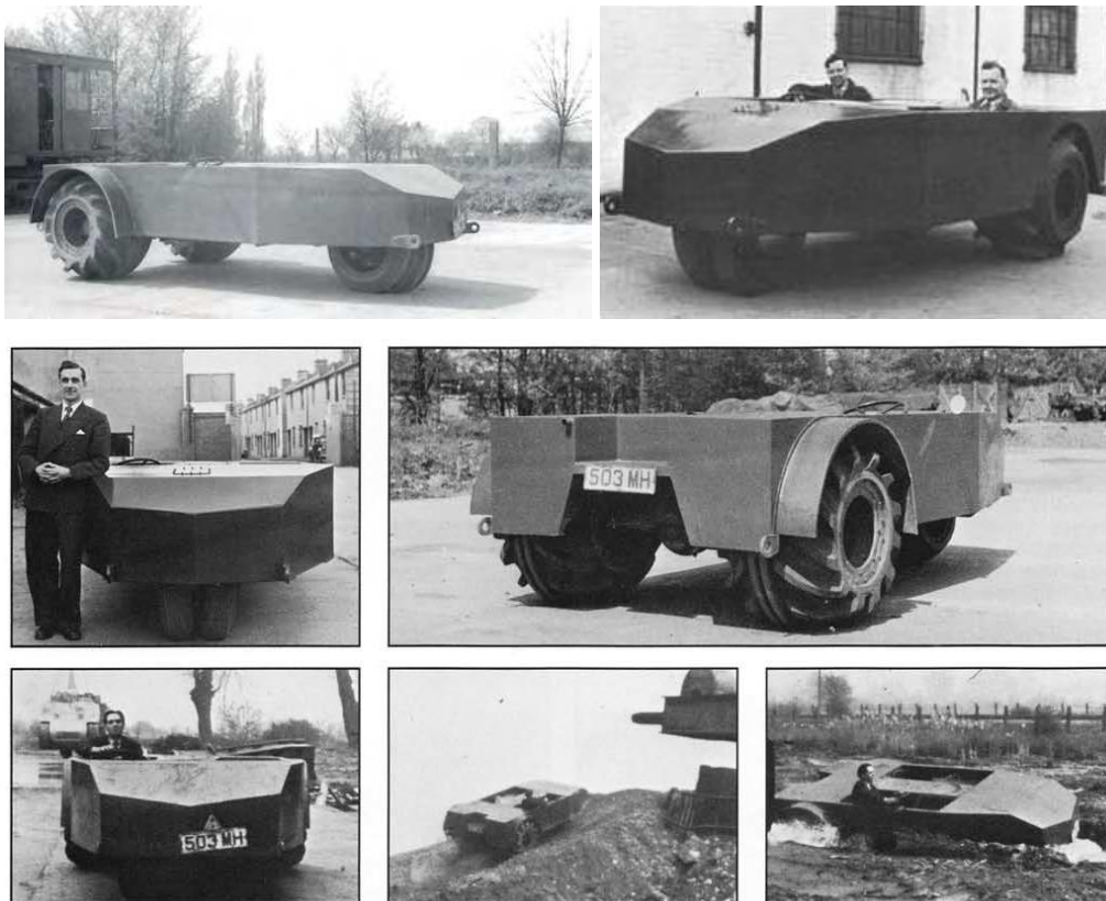
224. kép: A Straussler-féle háromkerekű légideszant jármű Lypsoid kerekes változata. 1302
