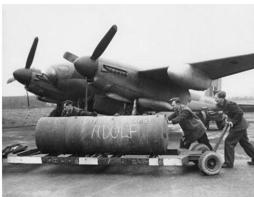
89. kép: Egy „HAPPY XMAS ADOLF” (Boldog karácsonyt Adolf) feliratú HC bombát egy Type D tréler segítségével rakodnak a világháború éveiben egy brit de Havilland Mosquito típusú repülőgéphez. 569
